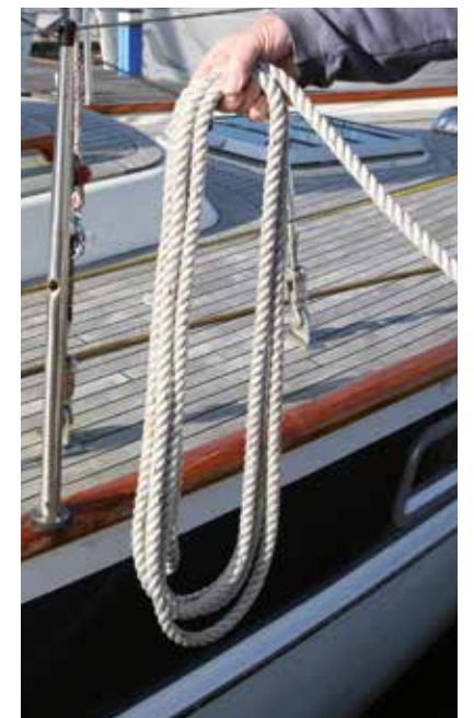
Schiet de lijn met de klok mee op; houd de slagen even lang
