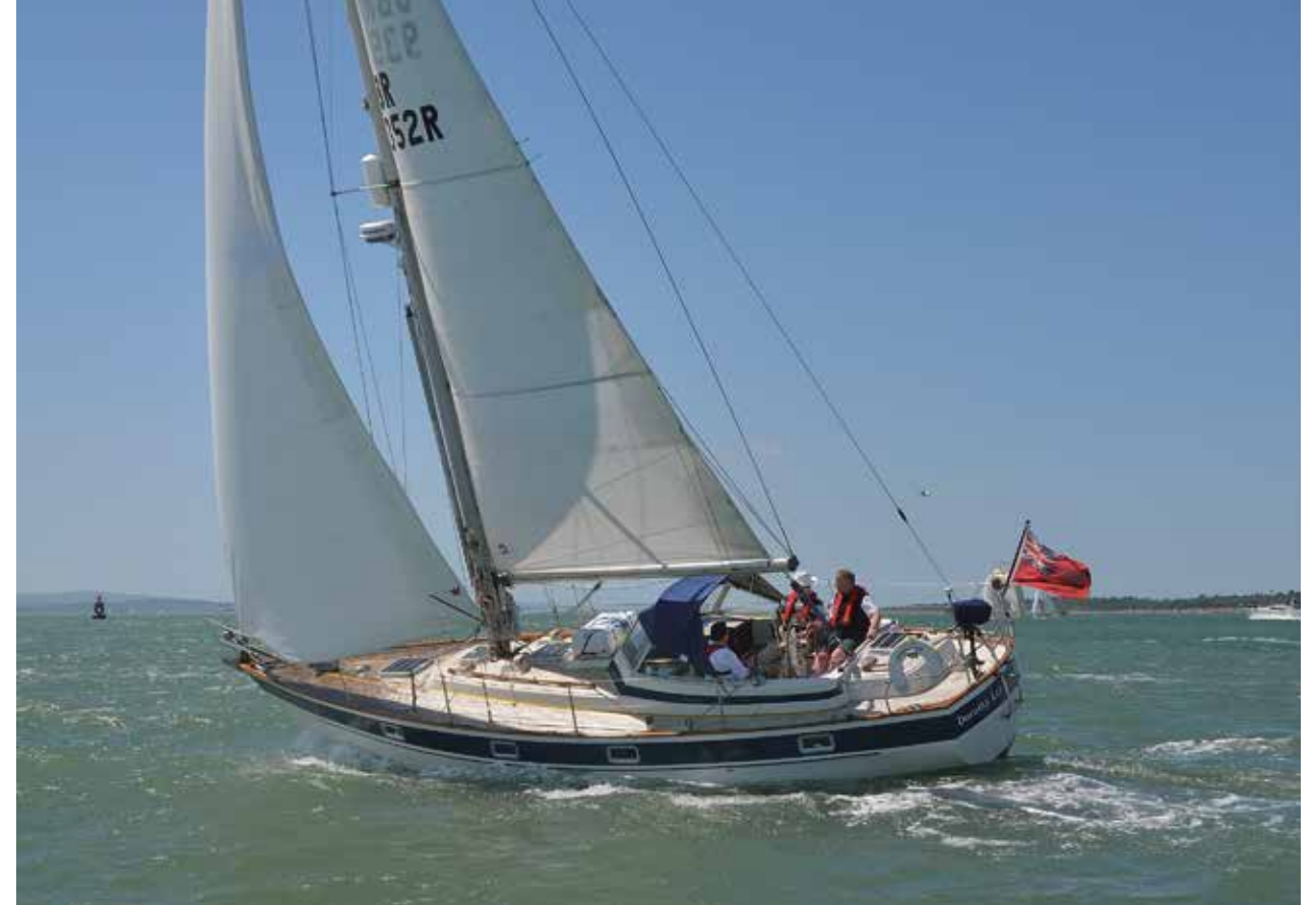
▲ Aan de wind, genuadeslede naar achteren, goede trim ▼ Ruime wind, genuadeslede naar voren, goede trim. Beide foto's: © Rich Buettner
