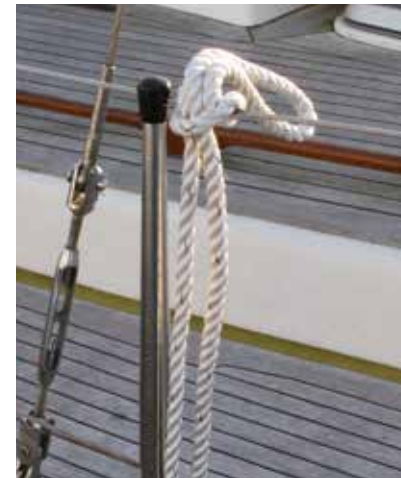
Stootwil zit met een mastworp met slipsteek vast
