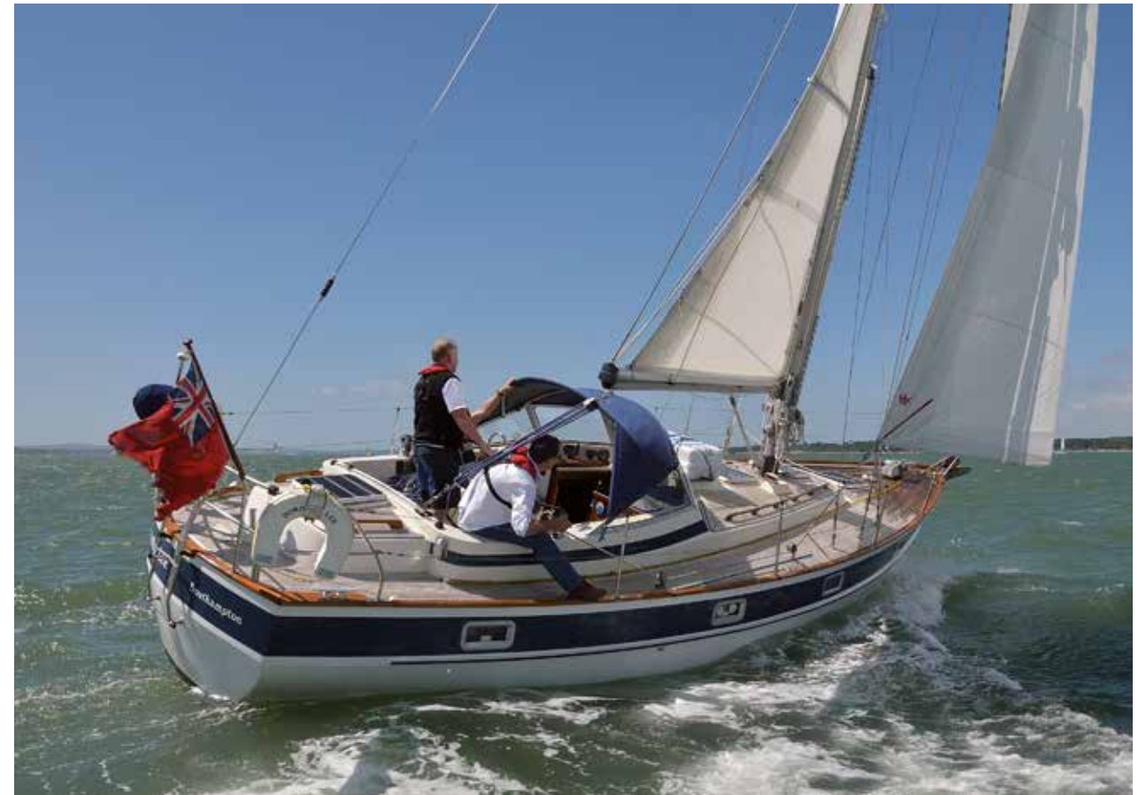
▲ Aan de wind, genuadeslede naar achteren, goede trim ▼ Ruime wind, genuadeslede naar voren, goede trim. Beide foto's: © Rich Buettner
