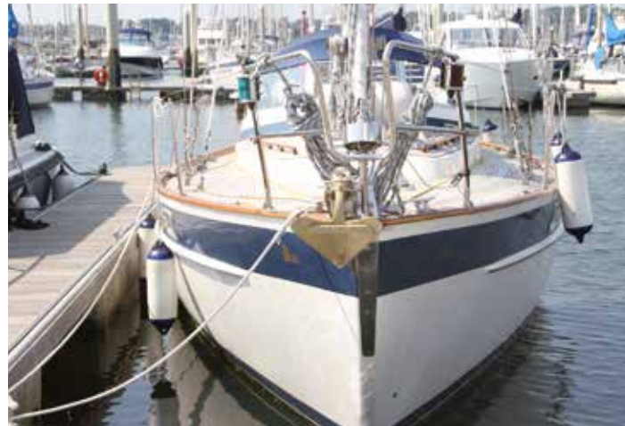
De stootwillen hangen aan de ene kant op steigerhoogte en aan de andere kant op stootrandhoogte
