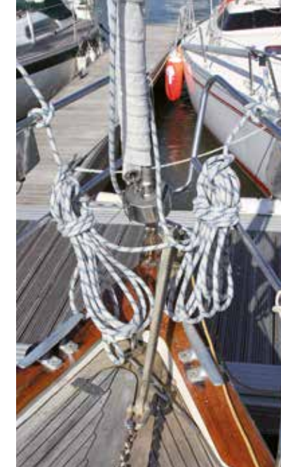
Fokkenschoten opgeschoten op de klimmersmanier
