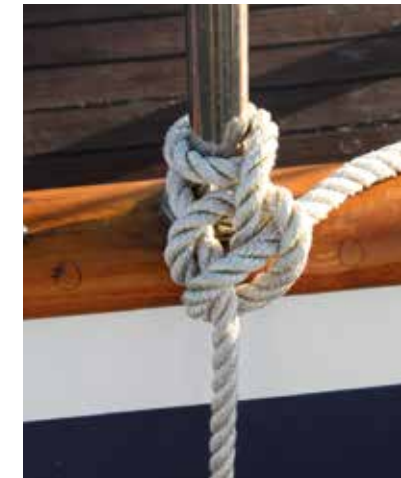
Stootwil aan de voet van een scepter met een rondtorn en twee halve steken
